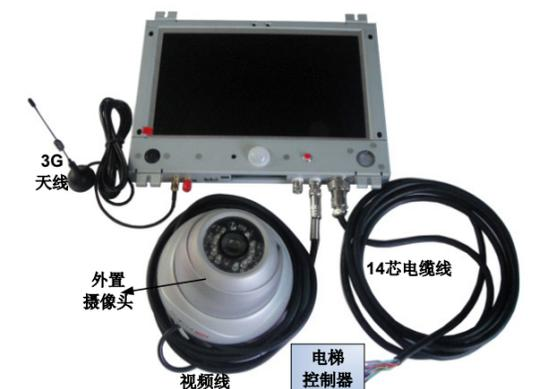
图9 IOT-WD3102D多媒体智能模块
