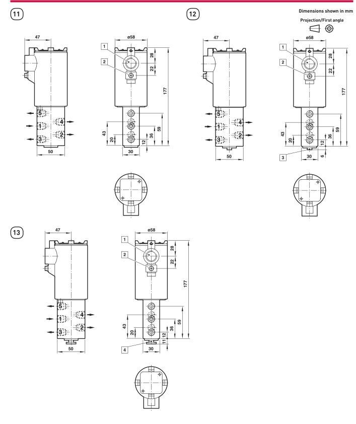
① Conduit connection M20 x 1,5 or 1/2 NPT ② External earth
